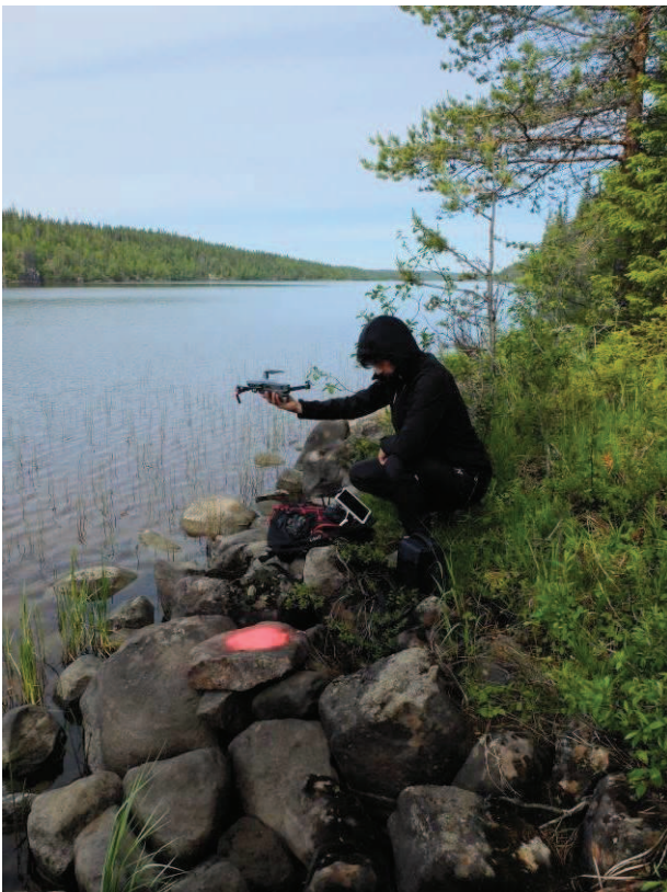
Kuva 19 Kartan tekoa drone -kuvauksella. Vasemmalla kuvaaja Jaakko Laihola ja oikealla kaavoittaja Kimmo Mustonen tukipisteen gps -mittauksessa
